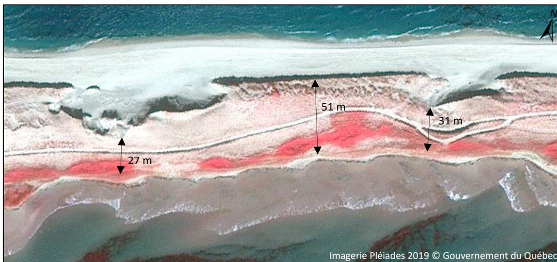
Figure 11 : Exemple de mesure de la largeur du milieu sableux dunifié (Baie Clarke, secteur de la Pointe de l'Est)
