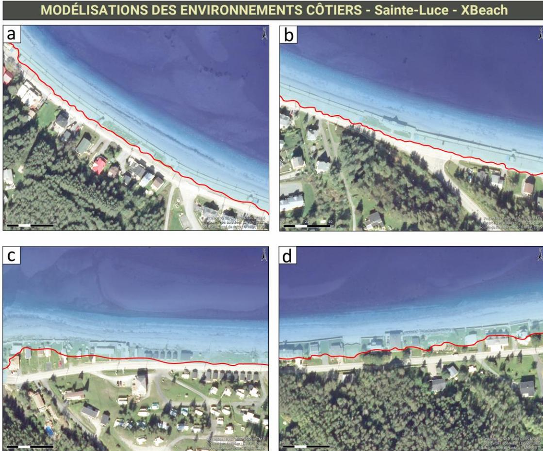
Figure 14: Quelques exemples de zones submergées dans la modélisation du 6 décembre 2010 à Sainte-Luce. La ligne rouge représente l'extension maximale de la nappe de submersion modélisée. a-b) Littoral ouest. c-d) Littoral est.
