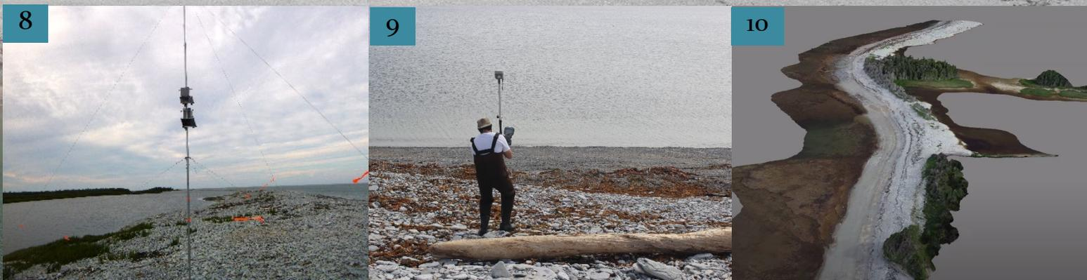
Figure 8 : caméra Reconyx capturant des images au 15 minutes du cordon littoral. Figure 9 : Charles réalise un profil topographique d'un cordon littoral à l'aide d'un DGPS. Figure 10 : reconstitution 3D à l'aide de photographies de la Baie Innommée en 2018.
