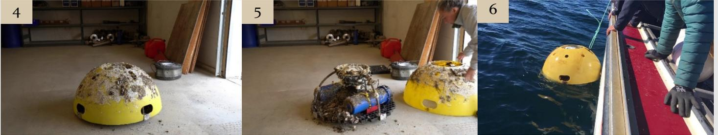
Figure 4 : AWAC récemment sorti de l'eau ; figure 5 : démontage et entretien de l'appareil ; figure 6 : remise à l'eau.
