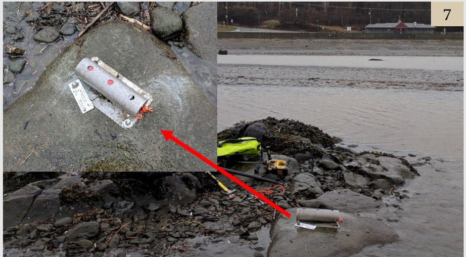
Figure 7 : capteur de pression à marée basse installé sur l'estran de Sainte-Luce;
