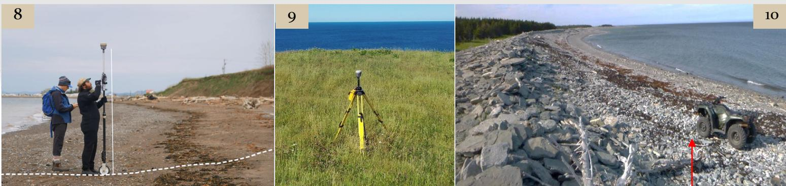
Figure 8 : relevé topo-morphologique en Gaspésie. Figure 9 : base fixe d'un DGPS.
