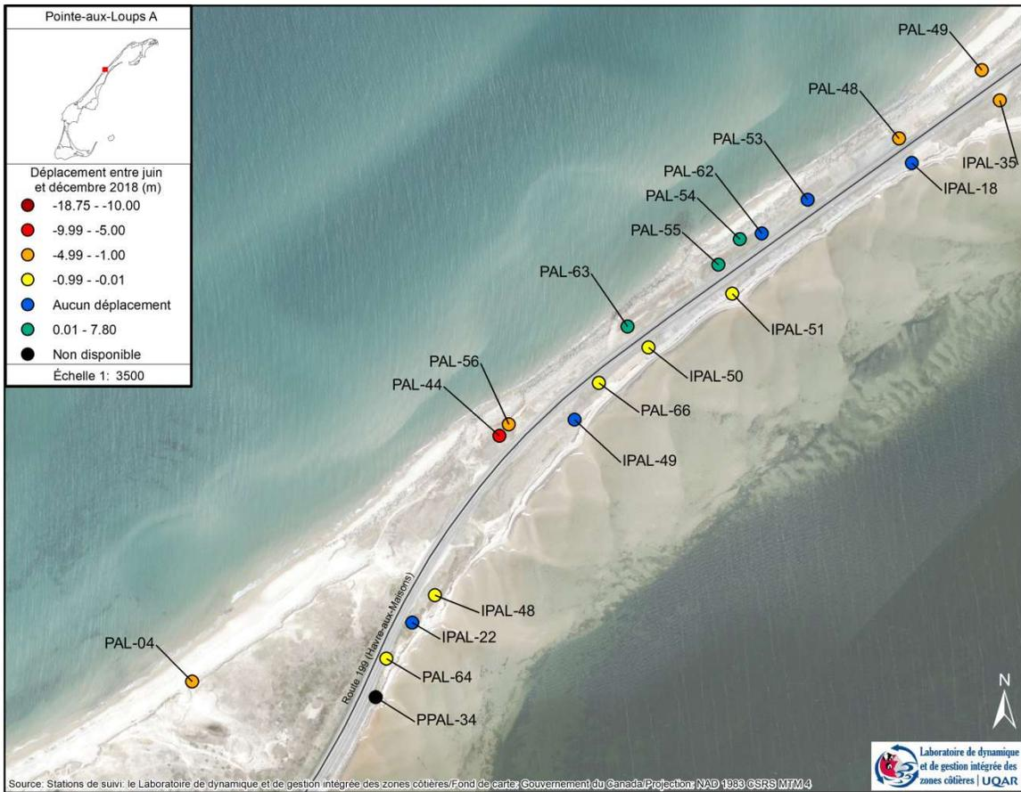
Figure 26. Localisation des stations de Pointe-aux-Loups (secteur A) mesurées lors du relevé de décembre 2018. À noter que la borne PPAL-34 affichant « non disponible » correspond à une station de type « infrastructure » ou seule la plus courte distance à la côte a été mesurée.
