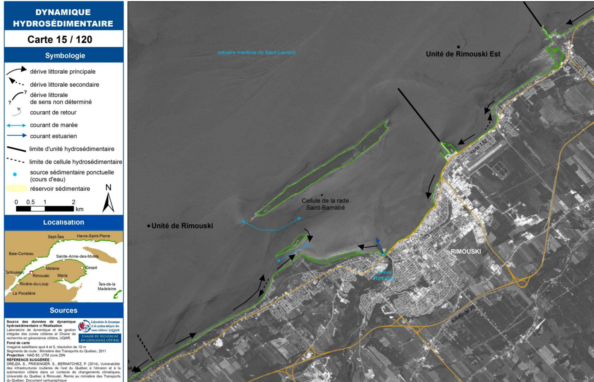
Figure 5. Exemple de cartographie de la dynamique hydrosédimentaire
