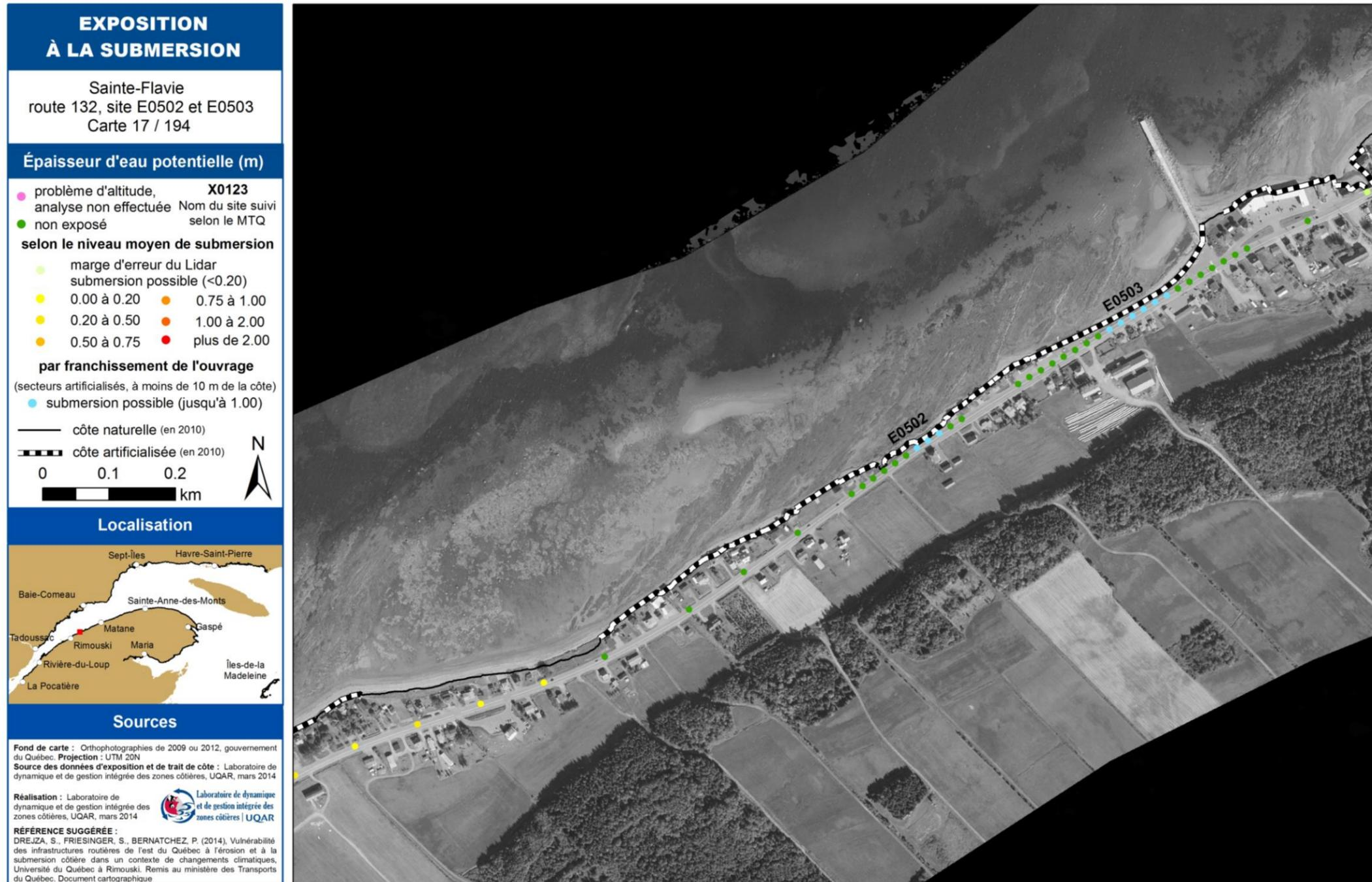
Figure 10. Exemple de cartographie de l'exposition à la submersion (sites suivis par le MTQ)
