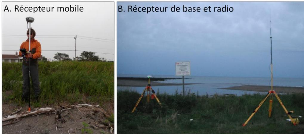
**Figure 23. Récepteur Trimble R8**
