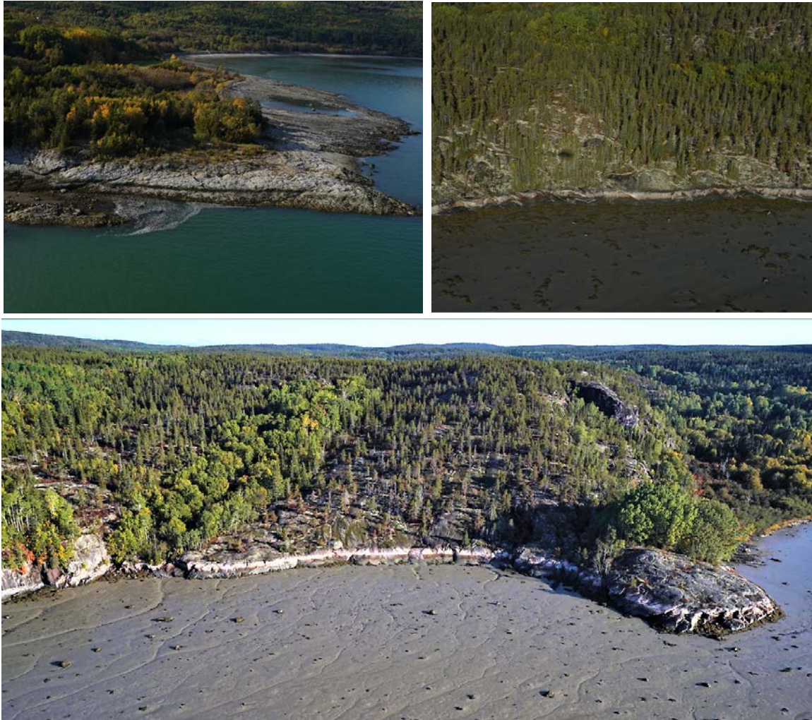
Figure 34. Utilisation du changement de couleur observé sur la roche comme élément d'interprétation pour situer la ligne de rivage
