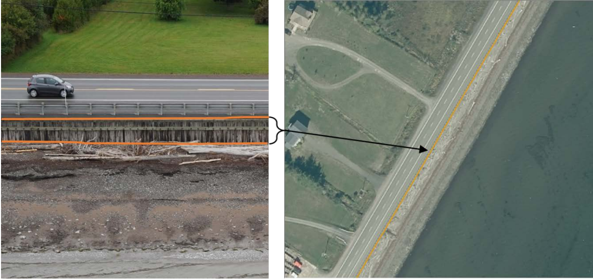
Figure 3. Exemple de situation où deux limites géomorphologiques distinctes sont numérisées par une seule ligne dans le SIG
