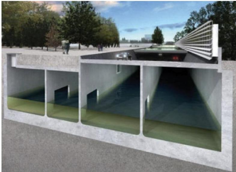
B. Illustration de stationnement prévu à Rotterdam pour le stockage de l'eau pluviale en cas d'épisode simultané de surcote et d'inondation fluviale.
