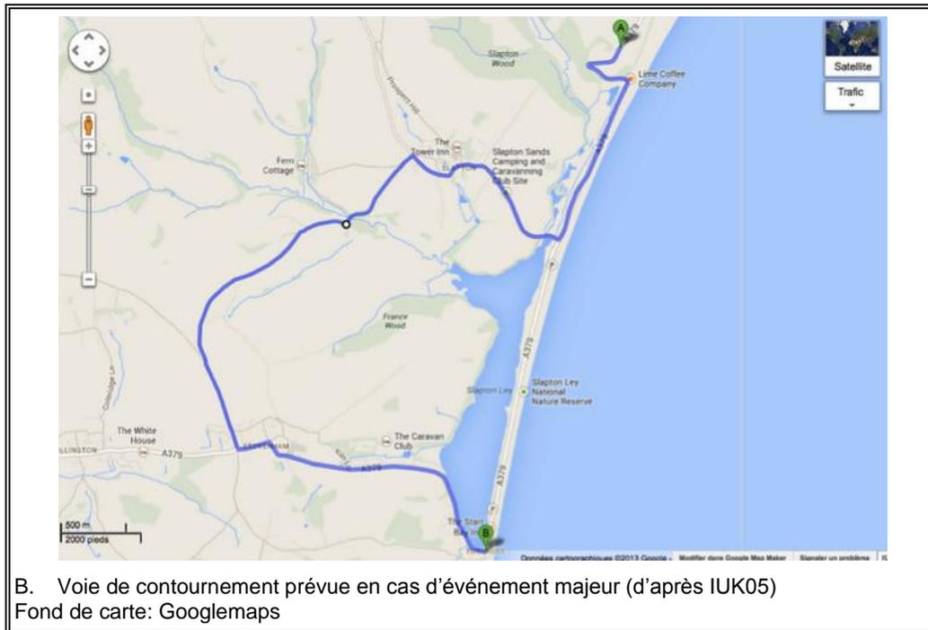
**Stratégie 31. Recul de la route suite à des dommages récurrents et voie de contournement temporaire. À l'instar de l'exemple de Slapton Sands, combiner le recul progressif d'un tronçon fréquemment endommagé par les aléas et la planification de voies de contournement temporaires pour faire face aux événements inévitables.**
