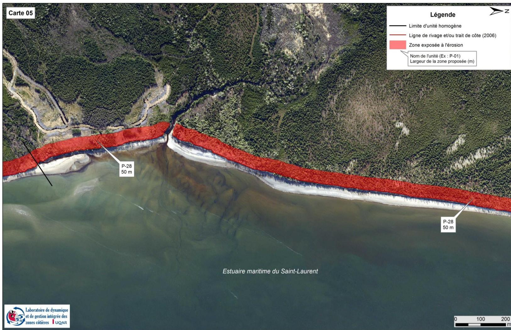
Figure 121. Zonage du risque d'érosion de la région de Pessamit entre 2006 et 2060, unité homogène P-28
