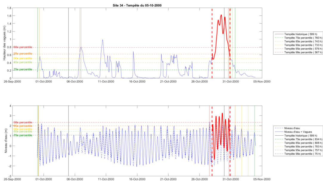
Figure 83 : Définition du début et la fin des événements météo-marins en fonction de valeurs inférieures au seuil de décision (exemple du site 34, 2000-10-05)
