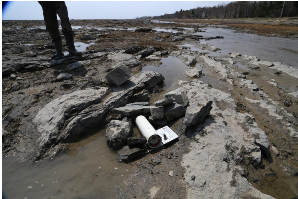
Figure 5 : Exemple de déploiement de capteur de pression sur la PFHM réalisé lors de la campagne C1 (12 au 16 mai 2014)
