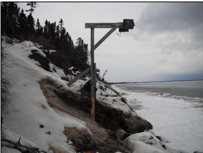
*Figure 4.2. Caméra côtière installée perpendiculairement à la côte*
