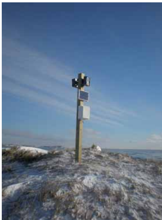
Figure 10. Caméras de suivi dans le secteur de la baie de Plaisance
